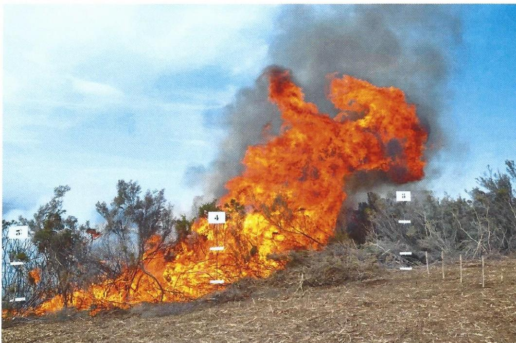
**Foto 5.** Extinción del fuego al entrar en contacto con la zona tratada con el agente extintor. Se puede observar que el fuego no sobrepasó el jalón nº 5 que marca el inicio de la zona tratada con el agente extintor (FIRELIMIT).
