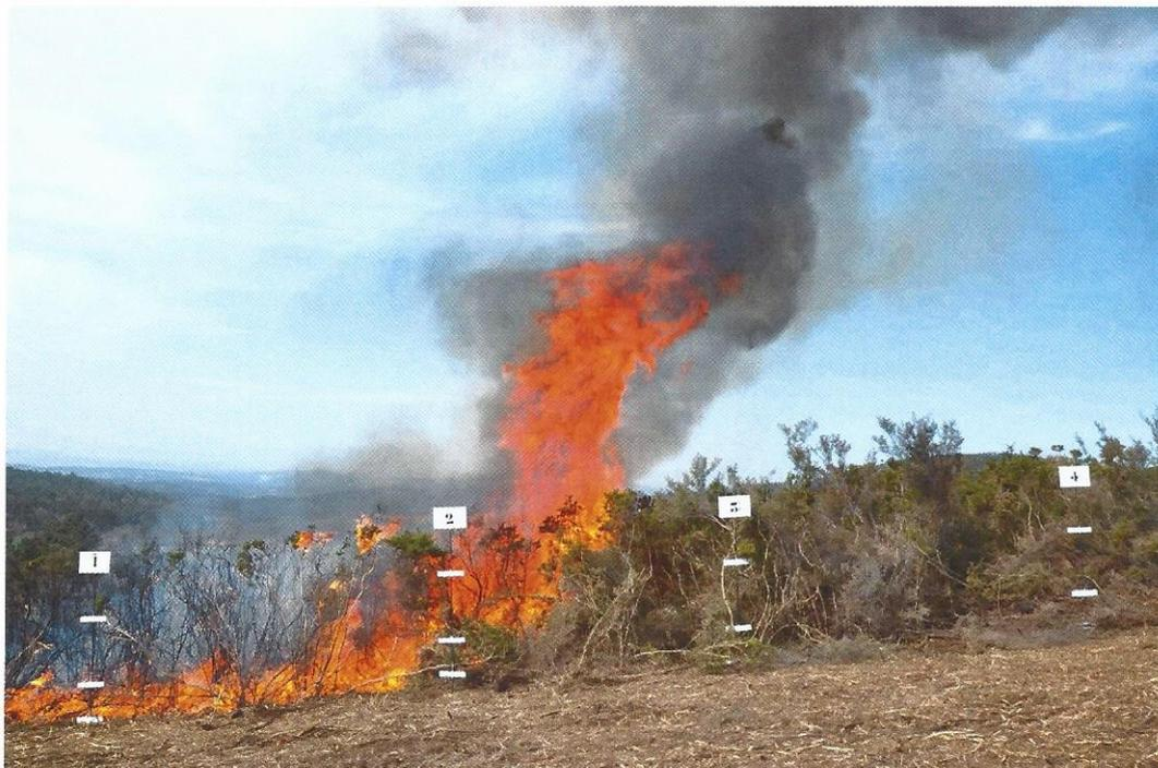
**Foto 4.** Momento em que el fuego llega al limite entre la zona sin y con agente extintor. Intensidad lineal (Byram) aproximada de 10.000 kw/m.
